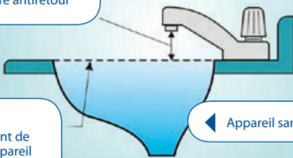
Par contre, le fait de raccorder un tuyau d'arrosage à un robinet enlève la coupure antiretour (dessin n° 3).
