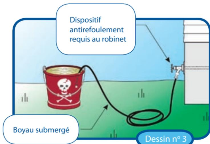
Un raccordement croisé devient alors possible et, par siphonnement à rebours, un poison peut contaminer le réseau d'eau potable. Un **dispositif antirefoulement** doit donc être ajouté au robinet comme protection. Notons que l'installation d'un clapet de retenue simple ne constitue pas une protection efficace : seuls les dispositifs antirefoulement approuvés selon la norme CSA/B64.10 assurent une telle protection.
